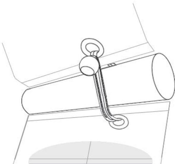
Fixer la bâche de toit et les panneaux latéraux avec le système d'œillet et d'élastiques.
