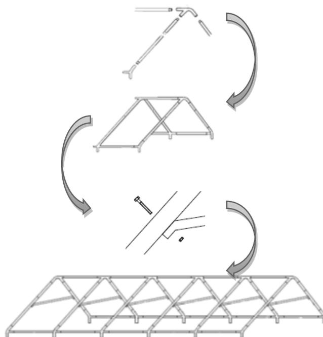
Emboîter les pièces du toit afin d'obtenir la structure ci-dessus. Verrouiller les tubes à l'aide des vis fournis.
